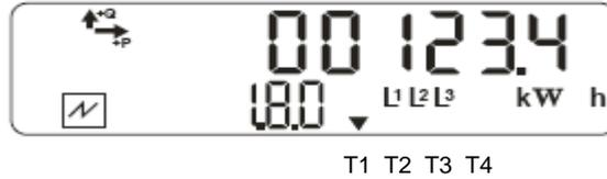
Es erscheinen nacheinander je ca. 8 Sek. lang die für die Abrechnung benötigten Werte. Im Beispiel oben sehen Sie die Anzeige des Zählerstandes **00123.4** für den Gesamt-Energiebezug, zu erkennen an der Kennziffer **1.8.0** in der unteren Zeile. An dieser Kennziffer erkennen Sie immer welcher Wert gerade angezeigt wird.
