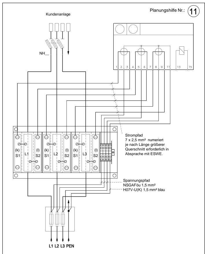
Die Meßleitungen sind ungeschnitten und getrennt nach Strom und Spannung in geschlossenem Kunststoffrohr ASCF - ACF von dem Wandlern zum Zähler zu verlegen. Der Spannungspfad ist von der Vorsicherung abzugreifen und über die Klemmen am Wandler zu führen.
