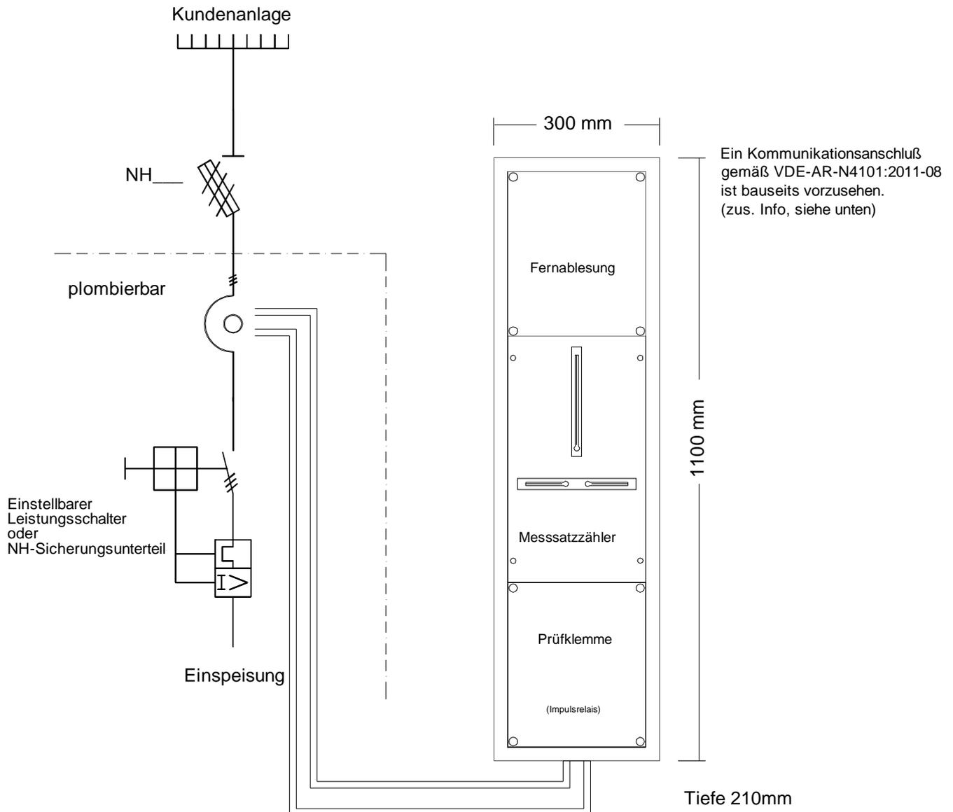
**Normzählerschrank nach DIN 43870 / DIN VDE 0603 komplett plombierbar.**
